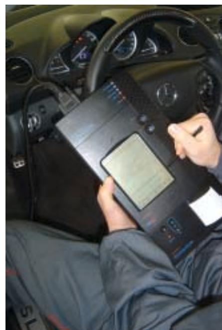
**A lato, il testo sul visore può essere capovolto in modo da orientare l'apparecchio nella direzione più comoda all'operatore.**
