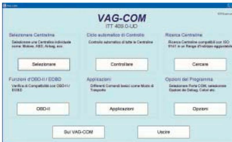
del programma vengono offerte diverse possibilità. Si può passare alla sezione che consente di interrogare una specifica centralina (motore, ABS, airbag, etc...) , oppure passare ad un ciclo automatico di controllo o alla ricerca di centraline diagnosticabili. Il primo caso, quello
